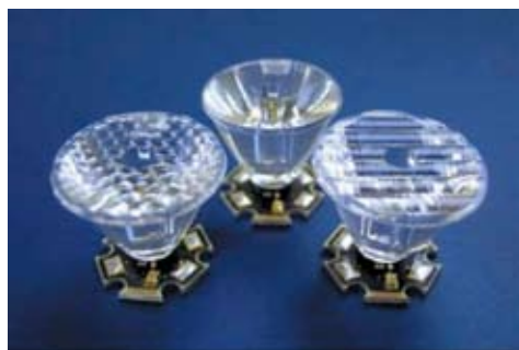
Рис. 3. Мощный светодиод на «звезде» с линзой
